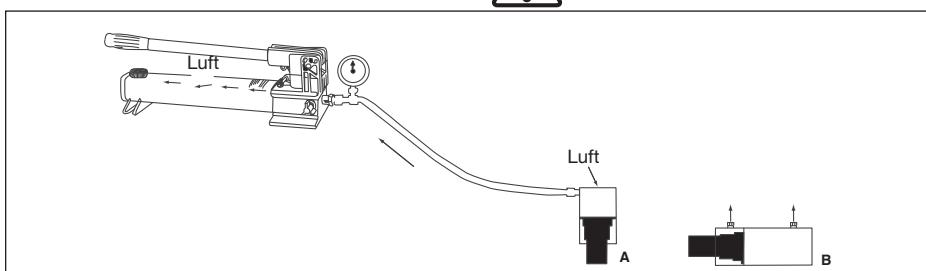
die Schläuche an BEIDE Kupplungen angeschlossen sind. Versuchen Sie nie, einen doppeltwirkenden Zylinder unter Druck zu setzen, wenn nur ein Schlauch angeschlossen ist.
